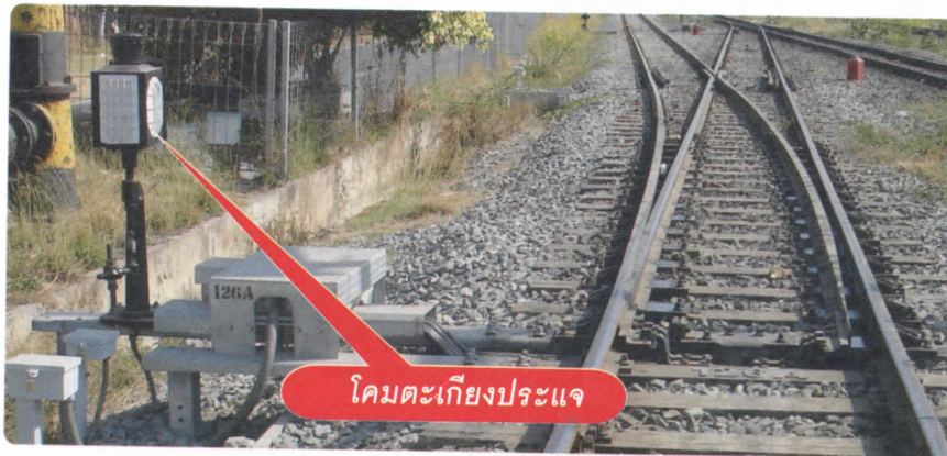
รูปแสดงโคมตะเกียงประแจ ของประแจกลหมู่ชนิดทำงานด้วยไฟฟ้า
