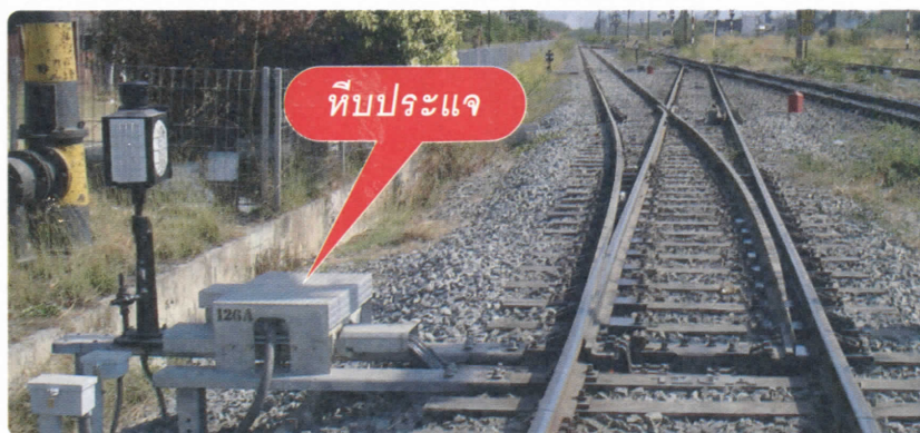
รูปแสดงทียบประแจ ของประแจกลหมู่ชนิดทำงานด้วยไฟฟ้า
