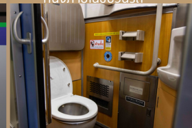
ห้องสุขาระบบปิด
