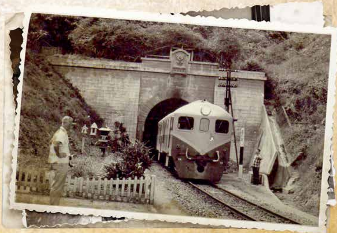
รถจักรดีเซล เอส แอล เอ็ม วินเตอร์เทอร์ รุ่น ๒๑ - ๒๒ เป็นรถจักรดีเซลรุ่นแรกๆที่นำมาใช้ในเมืองไทย
